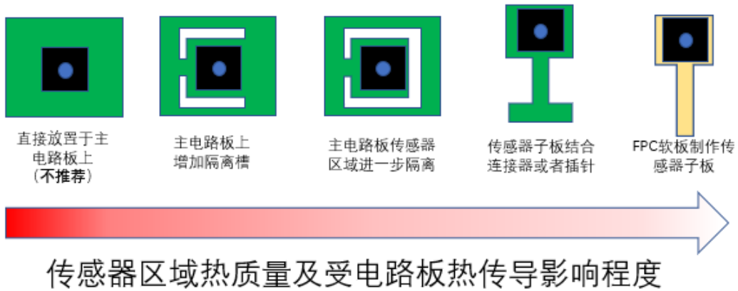
图5.8传感器区域热质量及受电路板热传导影响程度
