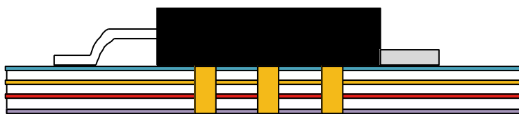
图 3.3 NSOPA2401 TO252 封装 建议 PCB 层叠结构
