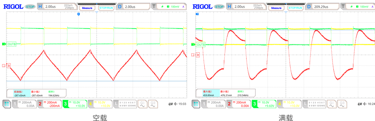
图4.4 空载和满载时的变压器电流波形
