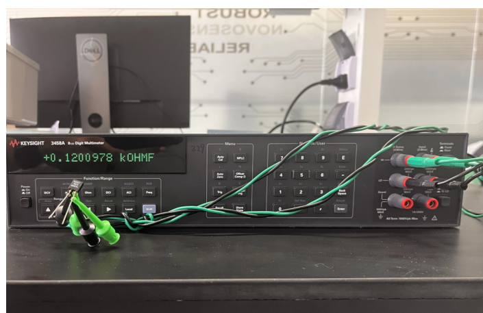
图 5-2 高精度金属铂电阻的标定
